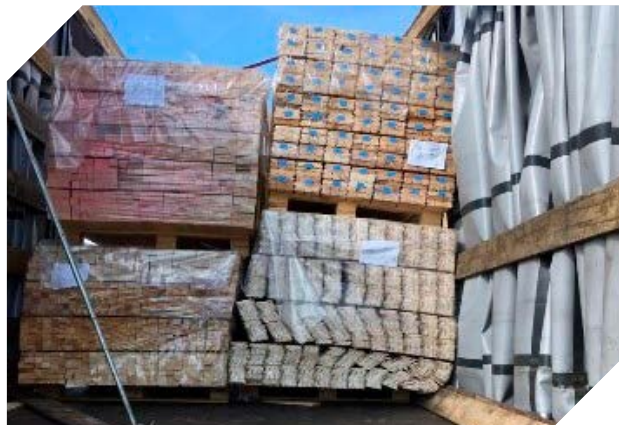
Общий вид поврежденного товара, которые позволяли бы сделать предположения о причинах повреждения, а также оценить положение и приблизительную степень натяжения крепежного ремня.
